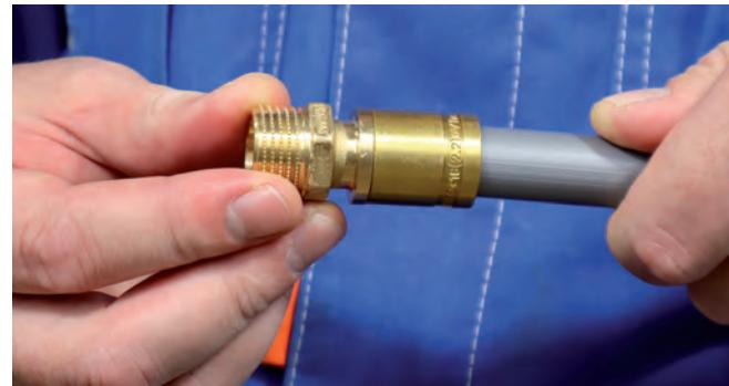
Для аксиальных латунных фитингов СИНИКОН необходимо использовать надвижные гильзы СИНИКОН. При использовании надвижных гильз сторонних производителей герметичность соединения не гарантируется и претензии не принимаются. После монтажа трубопровод должен пройти гидростатические испытания в соответствии с требованиями СП 73.13330.2016.
