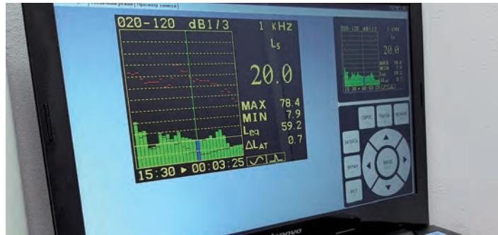
Для определения факторов, влияющих на уровень шума систем внутренней канализации из полимерных труб и разработки перспективной продукции с улучшенными параметрами по уровню шума на заводе компании «СИНИКОН» создана акустическая лаборатория.
